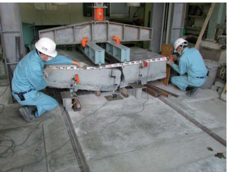
積みブロック (12A 裏込めコンクリート150mm) 荷重条件：②
