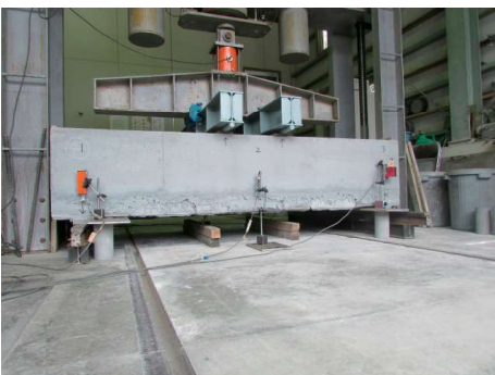
積みブロック (12A 裏込めコンクリート150mm) 荷重条件：②
