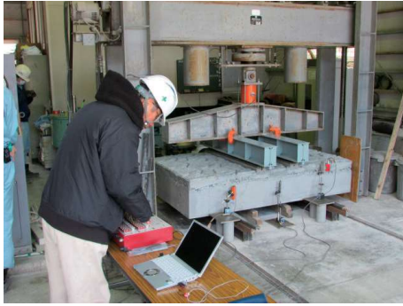
協会型大型積みブロック (基本 裏込めコンクリート150mm) 荷重条件：①
