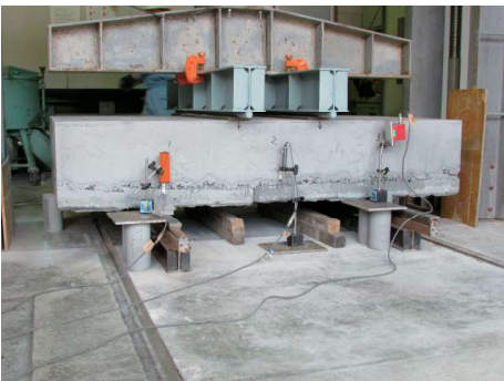
積みブロック (12A 裏込めコンクリート150mm) 荷重条件：②
