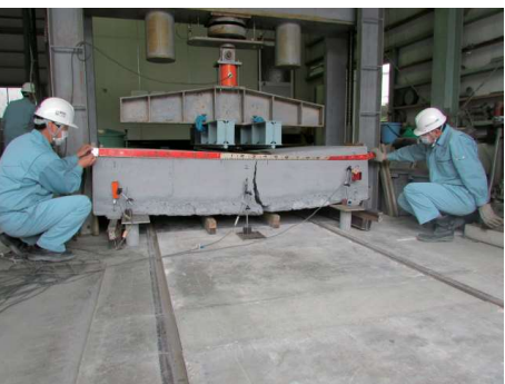
積みブロック (12A 裏込めコンクリート150mm) 荷重条件：②
