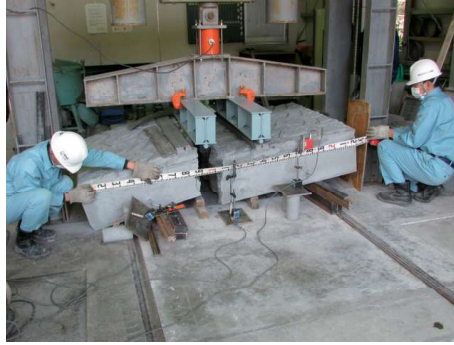
協会型大型積みブロック (基本 裏込めコンクリート150mm) 荷重条件：①
